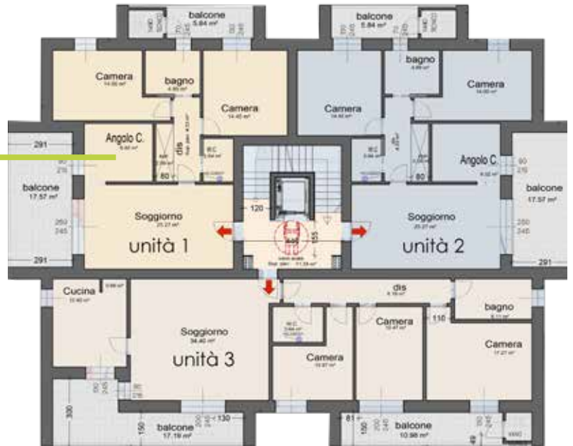
Palazzina 10 alloggi lotto A piano tipo 1,2 e 3
